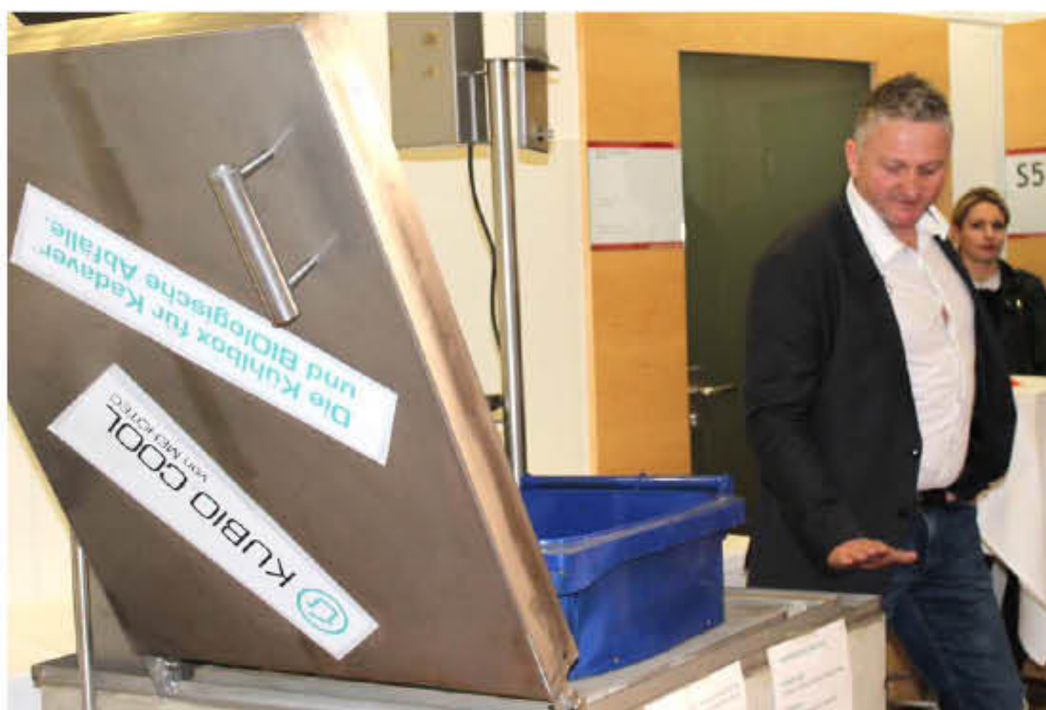
Bernhard Hoser hat eine Kühlbox zum Zwischenlagern von Kadavern und Bioabfall entwickelt, die keine Energie verbraucht.
